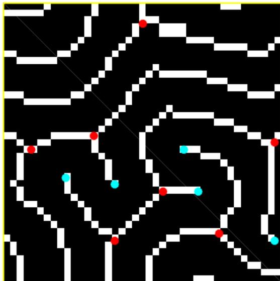
Для обнаружения дефектов скелета изображение разбивается на блоки  $3 \times 3$  пикселей. После этого подсчитывается число ненулевых пикселей, находящихся вокруг центра. Пиксель в центре считается дефектом (минуцией, *minutiae*), если он сам ненулевой, и соседних ненулевых пикселей один (дефект типа «окончание») или три (дефект типа «ветвление»).
