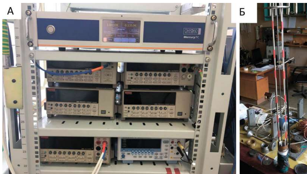
Рисунок 2.12 — А) Фотография стойки с измерительными приборами. Б) Сверхпроводящий соленоид с полем до 2 Тл, установленный в транспортный дьюар.
