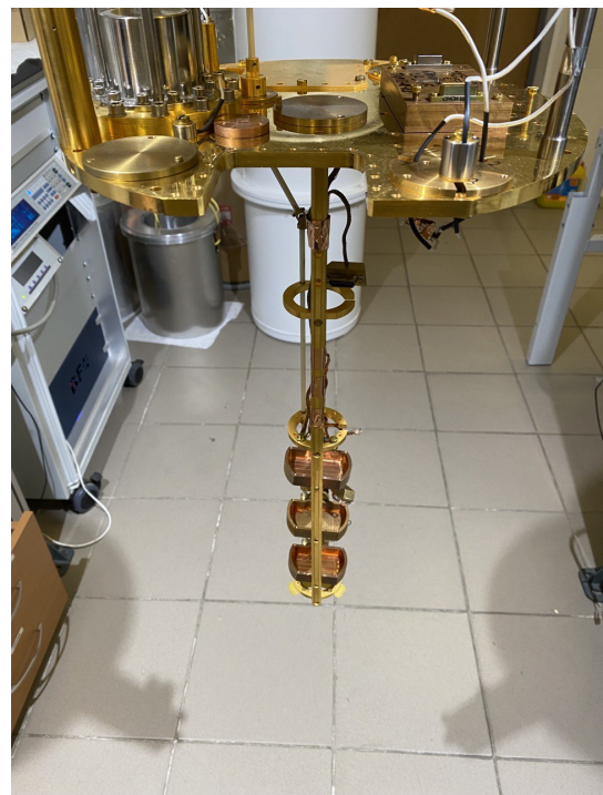
Рис. 2.7: Вид внутреннего устройства криостата Bluefors BF-LD250 [8] и фотография держателей под столики с образцами.
