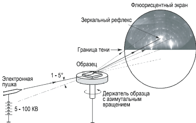
Рис. 3.12. Схема аппаратуры ДБЭ
