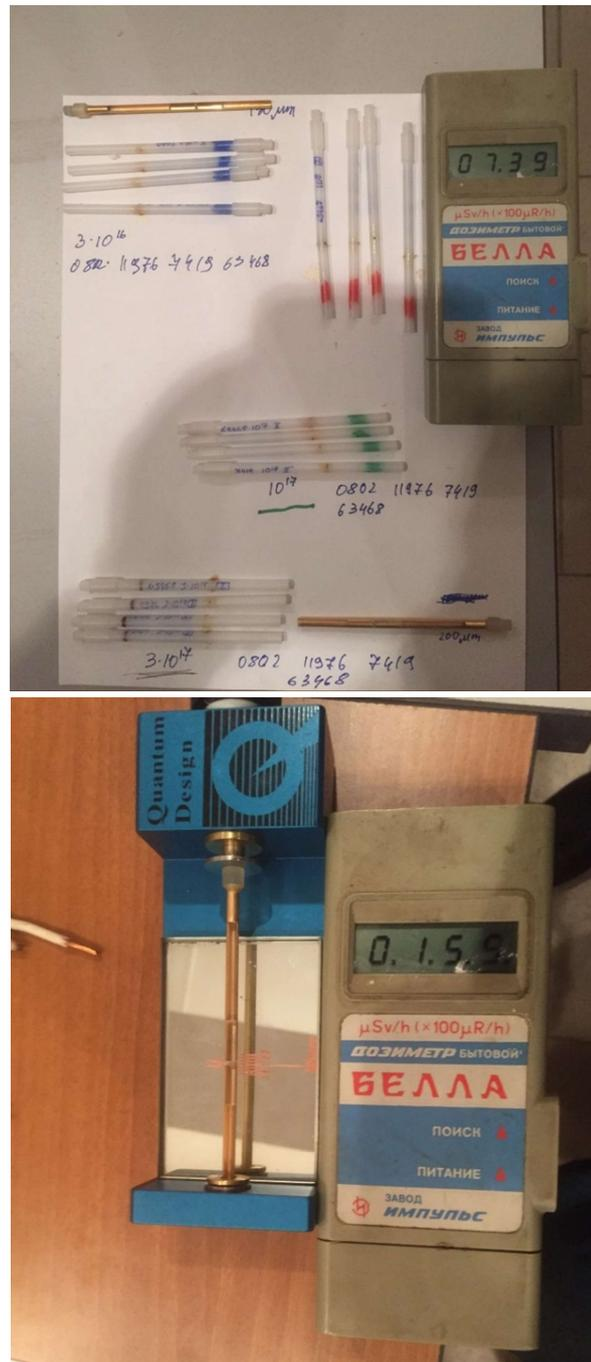
Рисунок 4.2 - Фотографии держателей (а) и оснастки (б) для точного позиционирования образцов
