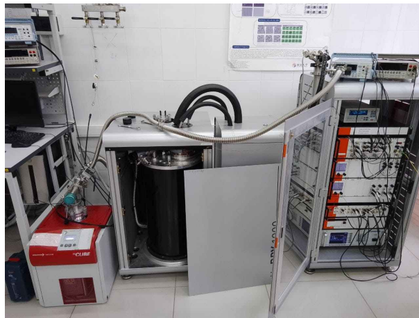
Рис. 6: Внешний вид криостат Attocube AttoDry1000.
