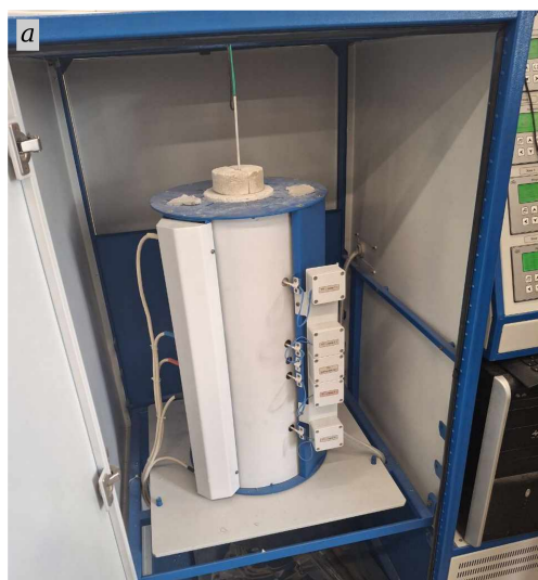
Рис. 2.1: Фотография печи, в которой выращивались кристаллы (а); качественный вид зависимости температуры от координаты вдоль оси печи (б). Черным прямоугольником выделена область, используемая для выращивания кристаллов
