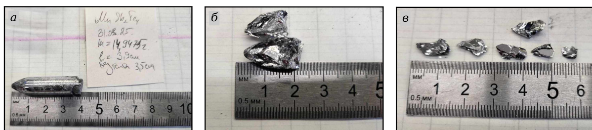
Рис. 3.2: Процесс отщепления образцов: только что выращенная «пуля» (а), после разбиения пополам (б), расщепление на достаточно однородные кристаллы (в)
