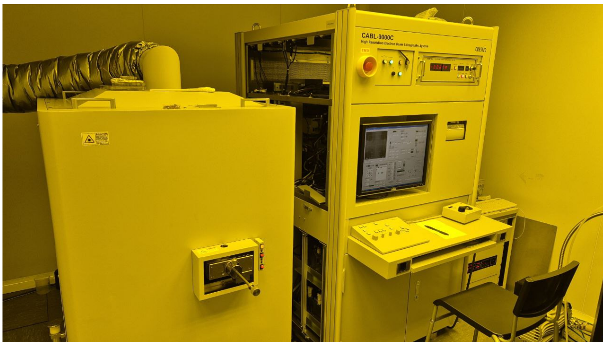
Рис. 2.2: Установка для электронной литографии Crestec CABL9000c, ЦКП МФТИ
