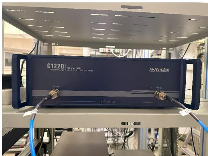
Рисунок 8 – Векторный анализатор цепей VNA Planar C1220.
