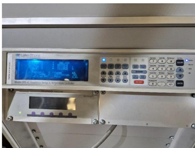
Рисунок 13 – Контроллер Lake Shore 372 температур фланцев криостата с возможностью подключения термометра.
