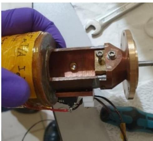
Рисунок 4 – Малый магнит, сделанный в лаборатории. Количество витков  $N = 1200$ , постоянная магнита  $k = 22,35$  мТл/А.
