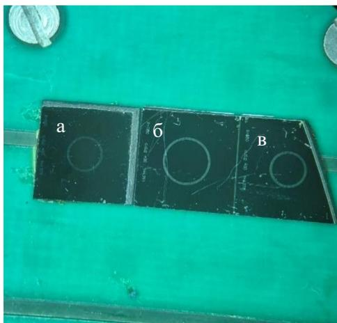
Рисунок 33 – SRRs на Si(100) подложке наклеены на MS (вид под микроскопом): а – сверхпроводящий Nb с  $R = 880$  мкм ( $f_0 = 7$  ГГц), б – гетероструктура с  $R = 1180$  мкм ( $f_0 = 5$  ГГц), в – гетероструктура с  $R = 880$  мкм ( $f_0 = 7$  ГГц).
