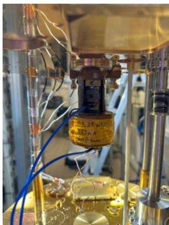
Рисунок 7 – Держатель в магните под плитой «4К» BlueFors, подготовленный к эксперименту.
