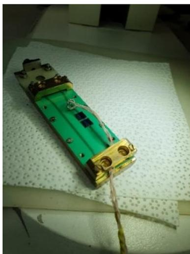
Рисунок 5 – Держатель для MS с термометром и Nb SRRs.
