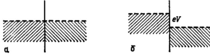
Рис. 7: Энергетическая диаграмма туннельного перехода между двумя нормальными металлами: а — при нулевом напряжении; б — при напряжении V , приводящем к сдвигу химических потенциалов на величину eV [12].
