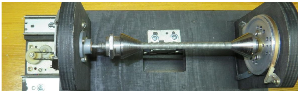
Рис. 2.23: (а) Установка для намотки соленоидов.
