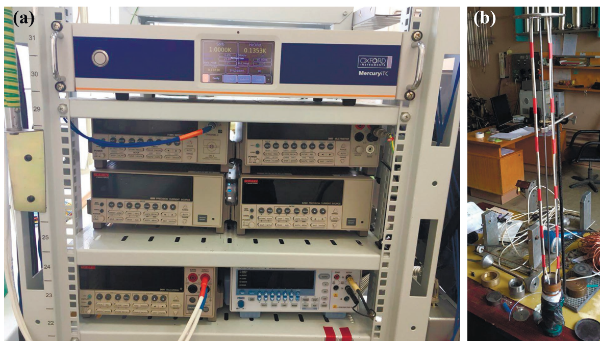
Рис. 2.22: (а) Фотография стойки с измерительными приборами. (б) Сверхпроводящий соленоид с полем до 2 Тл, установленный в транспортный дьюар.
