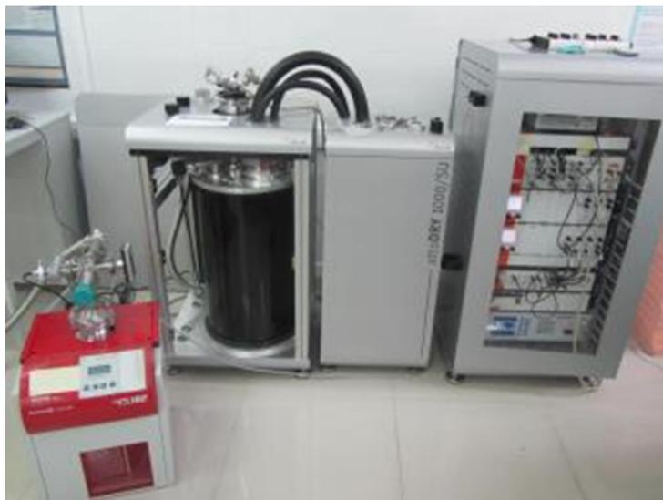
Рис. 2.6: Магнитно-силовой микроскоп AttoDry1000
