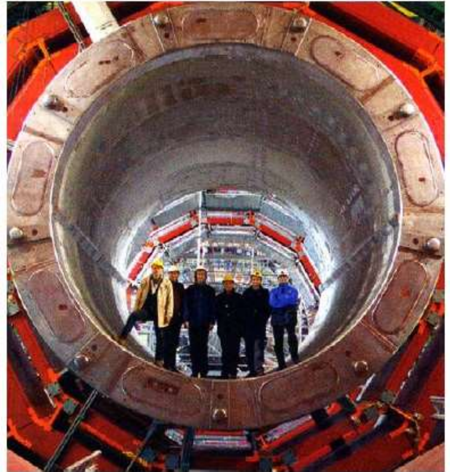
Рис.7. Сверхпроводящий соленоид (весом 224 т, включая около 15 т Nb-Ti сверхпроводящего кабеля) для детекторов частиц Большого адронного коллайдера
